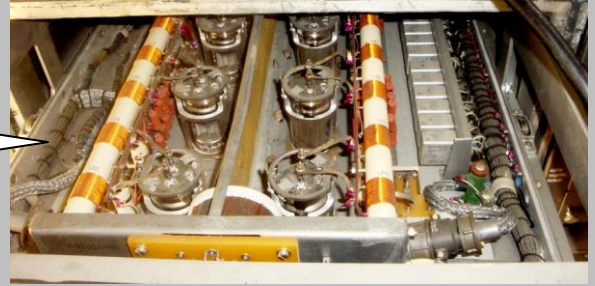
Апериодический (широкополосный) усилитель выполнен на восьми радиолампах типа ГУ-19
