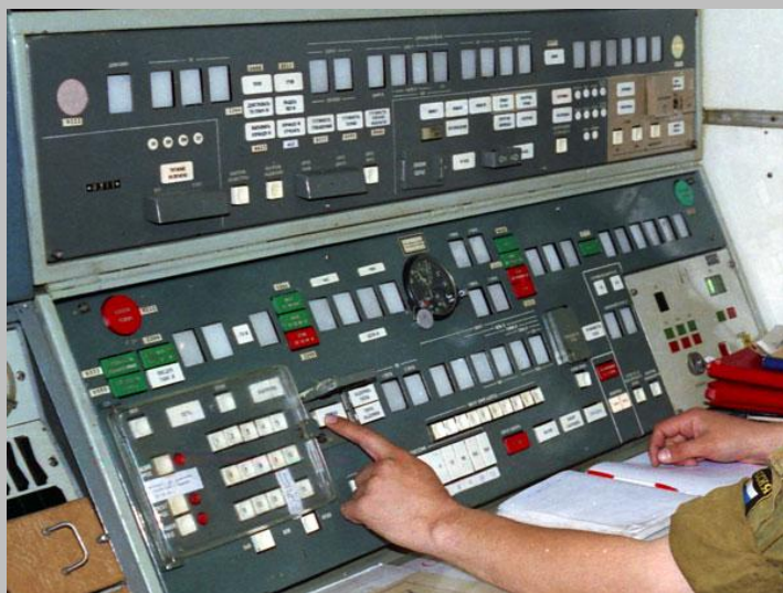
Табло аппаратуры АСБУ «Вьюга» (сверху) Пульт АСБУ «Сигнал-М» (снизу)
